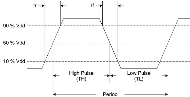
**Figure 10. LVCMOS Waveform Diagram<sup>[11]</sup>**
