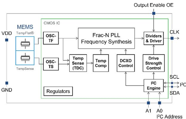
**Figure 30. Block Diagram**
