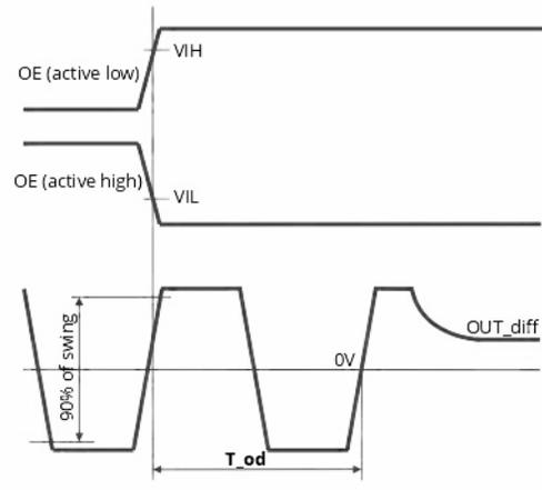
Figure 26. OE Pin Disable Timing ( $T_{od}$ )
